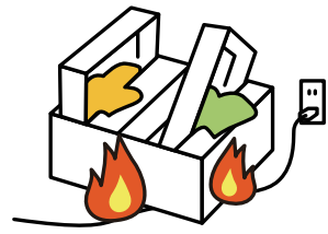
傷んだ配線の接触により出火
