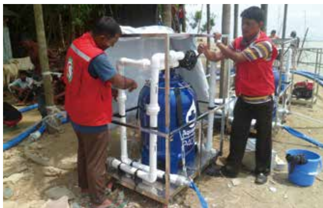
▲バングラデシュでの洪水救援で出動した給水・衛生キット (浄水ユニット：1時間で4,000リットルの浄水が可能) ©IFRC/BDRCS
