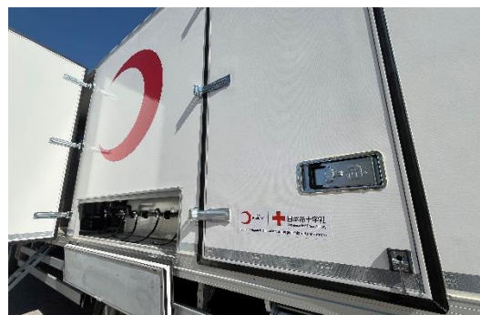
移動型浄水車両。荷台部分にフィルターなどを搭載、写真左側のホースのついた蛇口から処理された水が出る©JRCS
