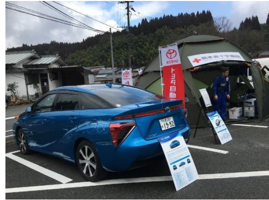
燃料電池車から救護所への電力供給実証©熊本赤十字病院
