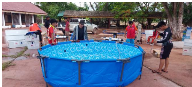
小型浄水キット(1時間あたり700リットルの浄水が可能)の展開準備をするラオス赤十字社職員
