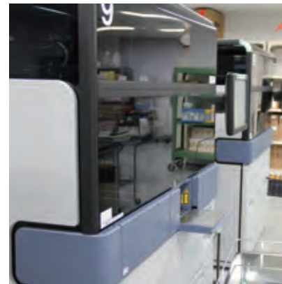
◀個別 NAT 用核酸増幅検査機 PANTHER システム (ノバルティス社)
