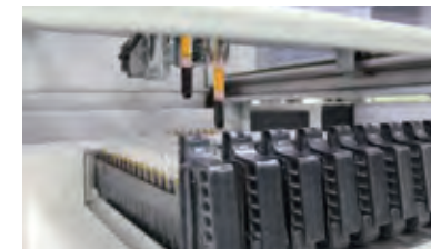
▲別の機械で検体を開栓・移載
