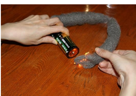
乾電池とアルミ箔又はスチールタワシで火起こし
