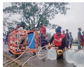
サイクロンで被災したバングラデシュ西部 Satkhira で展開された塩水処理装置稼働の様子 ©BDRCS
