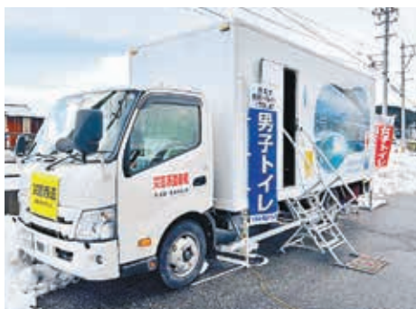
石川県珠洲市に派遣した大便器5基、小便器1基を備えた南あわじ市の水洗トイレカー
