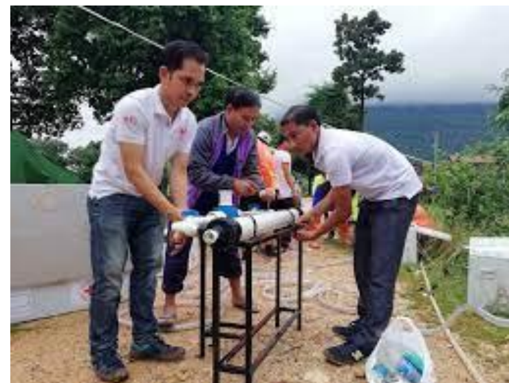
浄水ユニットの設営を急ぐ赤十字スタッフとボランティア
