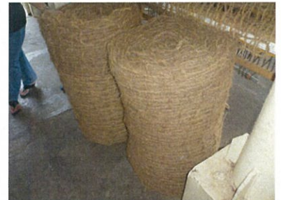
マットのロール。傾斜地の 土壌保全のため敷いて、草を生やす。
