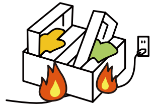
傷んだ配線の接触により出火
