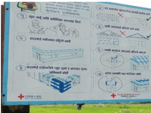
住宅の耐震性基準を説明した看板©ネパール赤十字社
